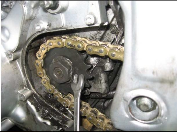
Il ne faut pas oublier de replier la rondelle sur l'écrou pour ne pas qu'il se dévise
