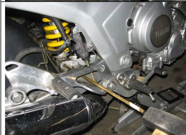
Puis on démonte l'axe de fixation de l'amortisseur
