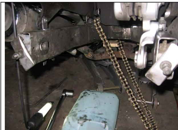
On passe la nouvelle chaîne dans le bras oscillant démonté
