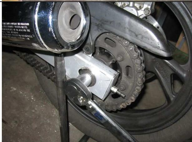
Maintenant que la roue arrière est levée, on va pouvoir l'enlever, je dévisse donc l'axe de la roue
