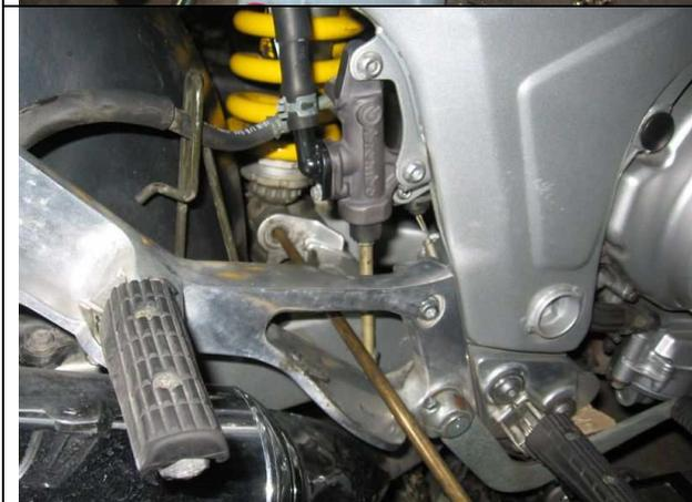
On re-fixe provisoirement l'amortisseur, cela vas faciliter le montage de l'axe principale du bras
