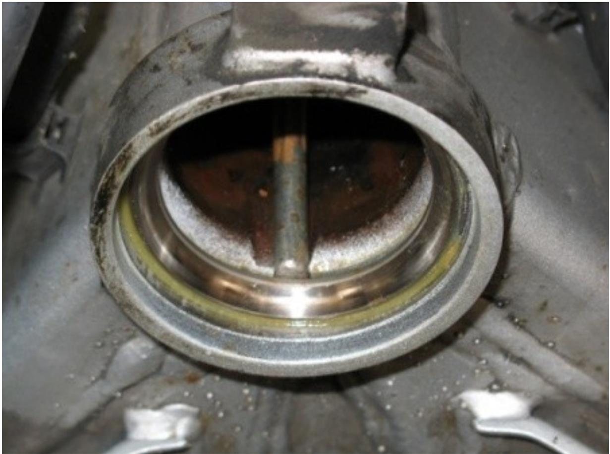
On peut voir que dans le tube du direction il y a un petit espace qui permet de positionner l'outil, il y en a un autre en face.
